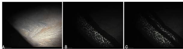
注: A 表示塌陷时的温度为 -34.9 °C; B 表示塌陷时的温度为 -37.9 °C; C 表示塌陷时的温度为 -38.7 °C
